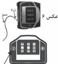
⚠ اگر نشانگر زرد روی سیم برق مشخص شد، توسط دکمه جمع کننده سیم برق را تا نشان سبز رنگ روی آن جمع کنید. در غیر اینصورت سیم ممکن است قطع شود و خطر شوک الکتریکی به همراه دارد (عکس ۶)
